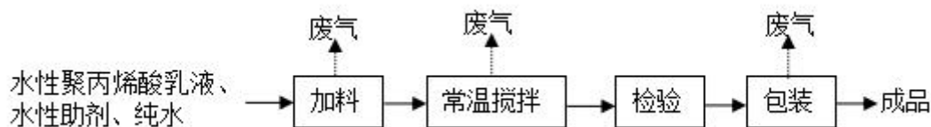
图 2-1 医药、食品专用水性包装胶生产工艺流程图及产污节点图
