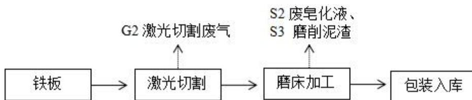
图 2-1 生产工艺流程及产污节点图
